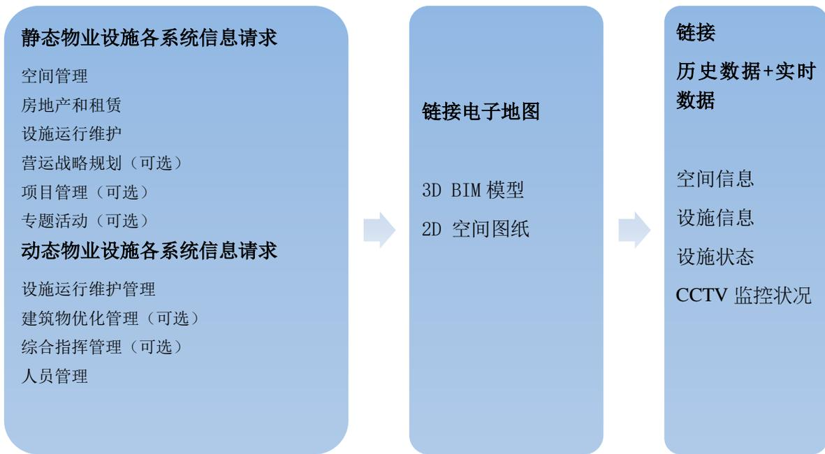
图：整合 BIM 电子地图流程框架
